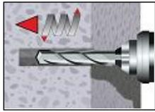
1. Bohrloch drehschlagend mit vorgeschriebenem Bohrernennendurchmesser (Tabelle B1) und gewählter Bohrlochtiefe erstellen.
