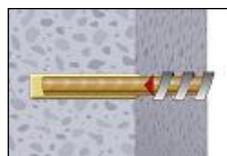
7. Befestigungselement mit leichten Drehbewegungen bis zur festgelegten Setztiefe einführen. Die Ankerstange muss schmutz-, fett-, und ölfrei sein.
