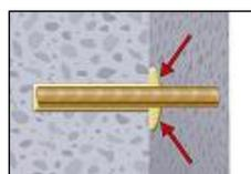
8. Nach Installation des Ankers sollte der Ringspalt komplett mit Mörtel ausgefüllt sein. Tritt keine Masse nach Erreichen der Setztiefe heraus, ist diese Voraussetzung nicht erfüllt und die Anwendung muss vor Beendigung der Verarbeitungszeit wiederholt werden. Bei Überkopfmontage ist die Ankerstange während der Aushärtung zu fixieren (z.B. Holzkeile).
