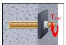
10. Nach vollständiger Aushärtung kann das Anbauteil mit dem zulässigen Drehmoment (Tabelle B1) montiert werden. Die Mutter muss mit einem kalibrierten Drehmomentschlüssel festgezogen werden.
