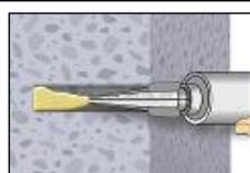
6. Gereinigtes Bohrloch vom Bohrlochgrund her ca. zu 2/3 mit Verbundmörtel befüllen. Langsames Zurückziehen des Statikmischers aus dem Bohrloch verhindert die Bildung von Lufteinschlüssen. Wird der Bohrlochgrund nicht erreicht, muss eine passende Mischerverlängerung verwendet werden. Die temperaturrelevanten Verarbeitungszeiten (Tabelle B3) sind zu beachten.
