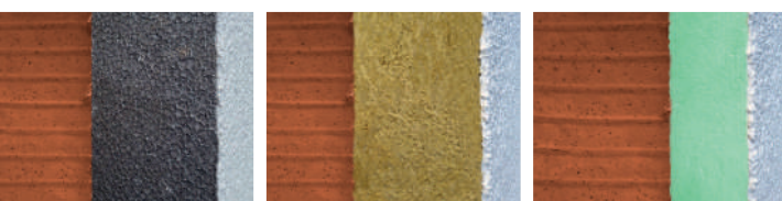
Beispiel: Hochlochziegel, Styropor, Putz
