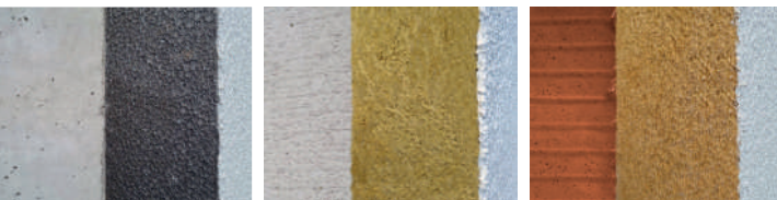
Beispiel: Beton, Styropor, Putz
