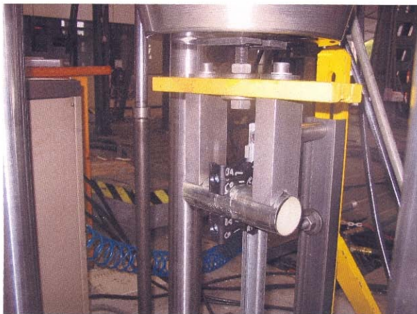
MONTAJE A CORTADURA
