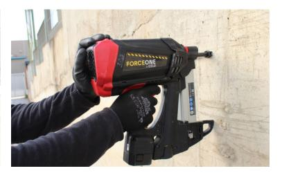
Fijación para múltiples materiales base como: chapas de acero, aislamiento, listones de madera, perfiles para placas de yeso, entre otros.
